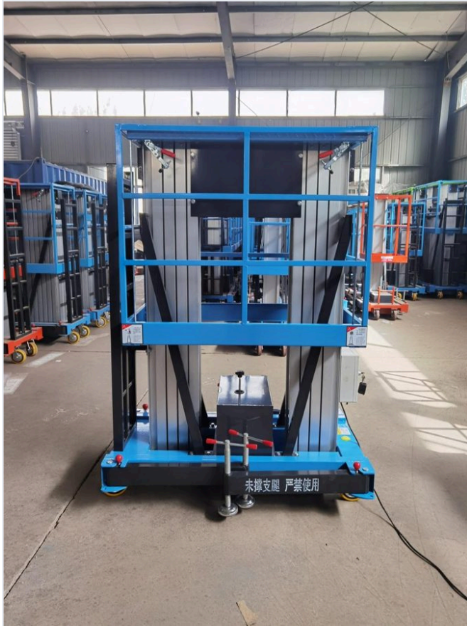
Foto real de la unidad SJYL0.23-6 — mástil de aluminio doble, chasis con ruedas y estabilizadores manuales.
