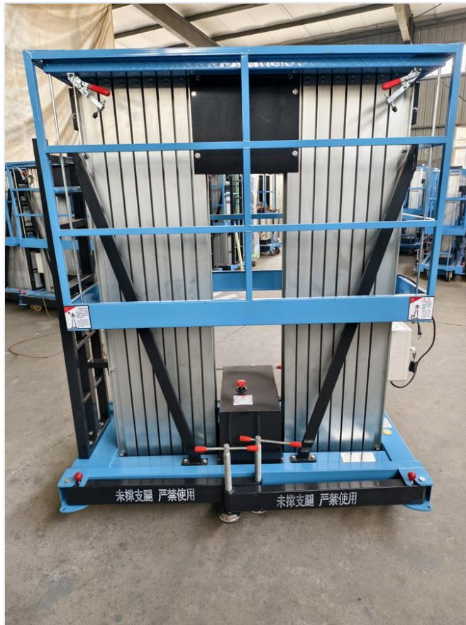
Foto real de la unidad SJYL0.22-12 — mástil de aluminio doble, chasis con ruedas y estabilizadores manuales.
