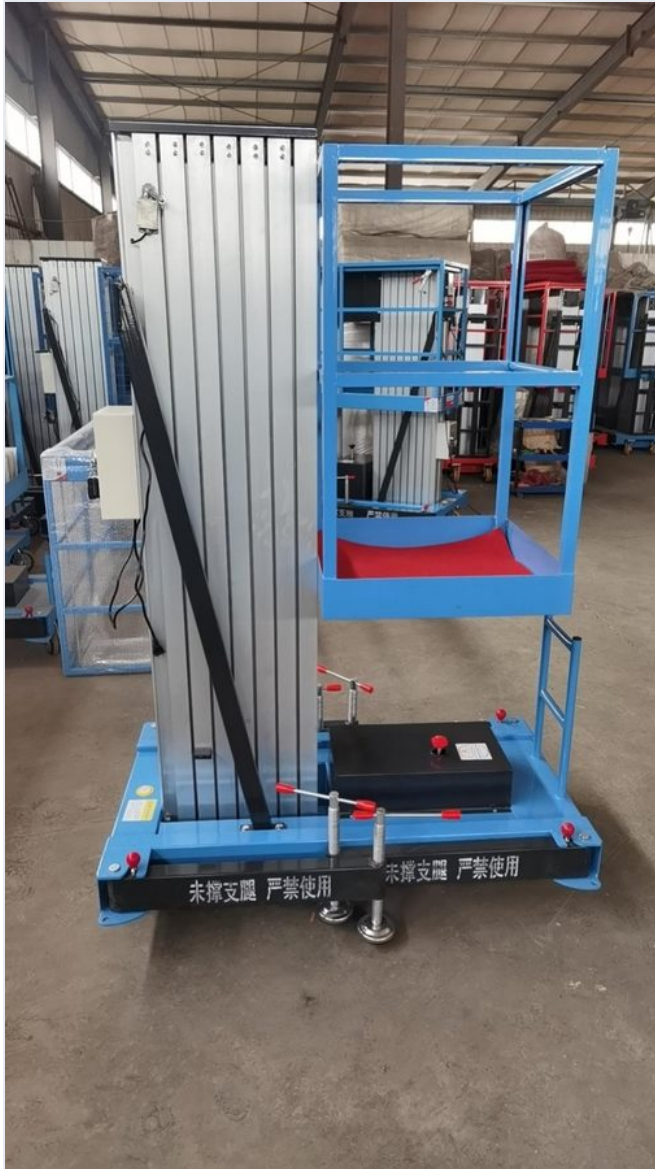
Foto real de la unidad SJY0.1-9 — mástil de aluminio simple, chasis con ruedas y estabilizadores manuales.
