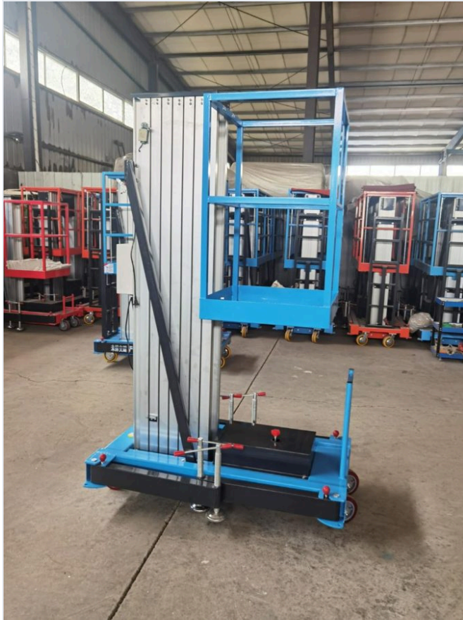
Foto real de la unidad SJY0.1-10 — mástil de aluminio simple, chasis con ruedas y estabilizadores manuales.
